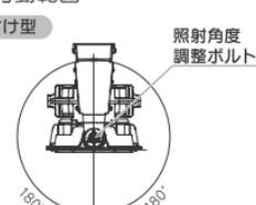
器具 取付穴寸法 推奨取付ボルトサイズ: M16
